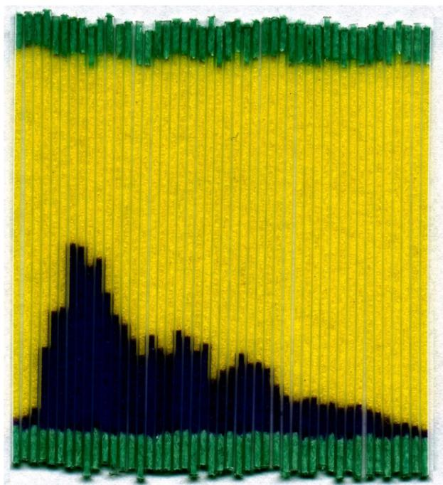
**Рис. 1. Характер изменения содержания аммиака в воздухе ротовой полости. Измерения выполнены капиллярными индикаторными трубками последовательно во времени. Время отбора пробы одной трубкой – 30 секунд.**
