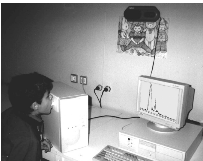
Рис. 3. Выполнение методики ХЕЛИК-тест с использованием экспериментального образца спектрометра ионного дрейфа в ФГУЗ «Детская Городская Клиническая больница № 5 им. Н.Ф.Филатова».
